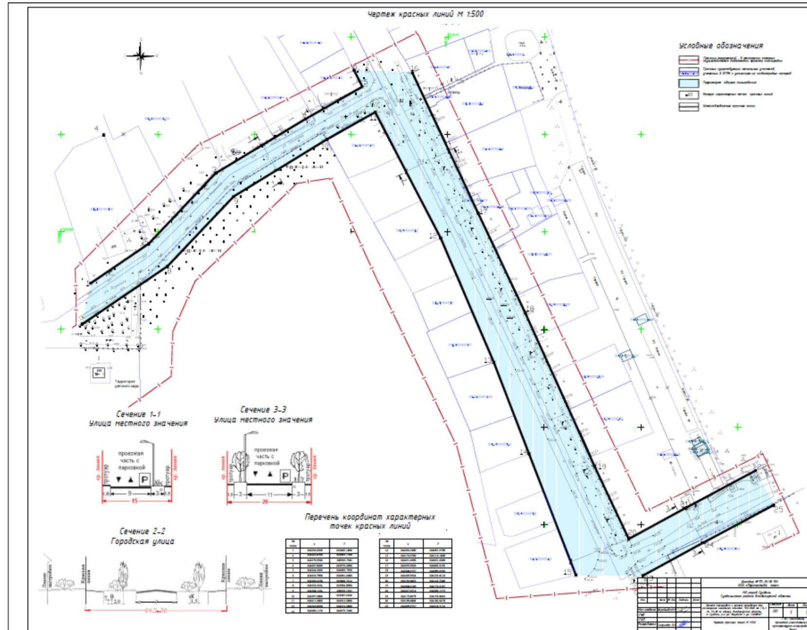
Чертеж границ зон планируемого размещения кабельной линии электропередач
